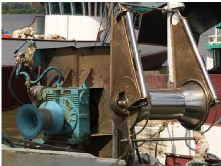
**Figura 15:** Equipamento utilizado em embarcações de médio e grande porte para o recolhimento de redes malhadeiras nas pescarias da costa norte do Brasil.
